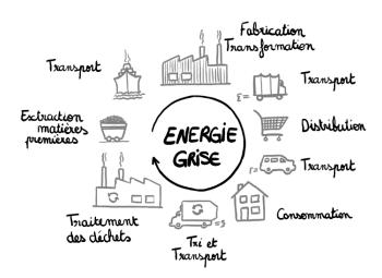
Afin de réduire l'empreinte carbone d'un bâtiment, il est possible de limiter ses besoins futurs en chauffage/rafraichissement avec un travail sur la composition de son enveloppe, mais également de sélectionner des matériaux dont le cycle de production est vertueux. En effet, avant d'arriver sur un chantier, un matériau a
